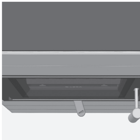
Obr. 4.6 Páčka spalovacího vzduchu úplně vpravo, přívod spalovacího vzduchu zcela otevřený, zatápění
