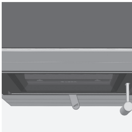
Obr. 4.4 Páčka spalovacího vzduchu úplně vpravo, přívod spalovacího vzduchu zcela otevřený, zatápění
