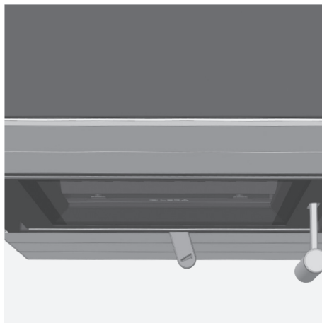
Obr. 4.10 Páčka spalovacího vzduchu úplně vpravo, přívod spalovacího vzduchu zcela otevřený, zatápění
