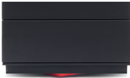
Obr. 4.26 LED signalizace „ČERVENÉ blikající“ – i po skončení hoření
