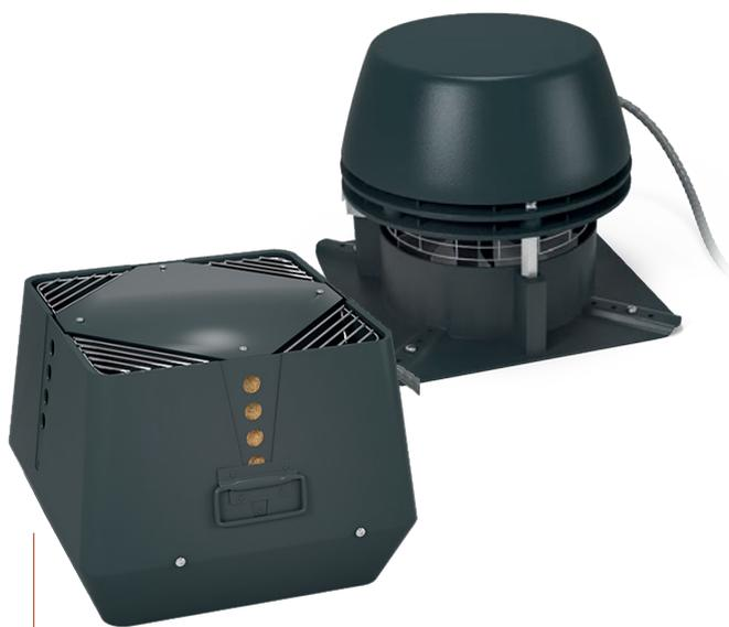
Saugzuggebläse Fabrikat exodraft RS014. Die Ausführung mit horizontalem Auswurf schützt den Schornstein zusätzlich vor Regen. Zur Reinigung aufklappbar.
